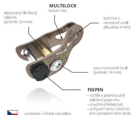
Katana FX je kotvítko pro popruhy o šířce 35 mm. Je dimenzována pro systémy do 16 kN tahu. Upínací mechanismus umožňuje předepnutí popruhu v jednom směru, zatímco v druhém směru je popruh pevně ukotven. Díky obřím hranám Katany nehrozí poškození popruhu. Středová osa o průměru 24 mm zachovává více než 85% pevnosti popruhu. Bočnice poskytují dostatečný prostor pro ukotvení dvou popruhů současně. Katana FX je kompatibilní s většinou dostupných spojovacích prvků (šekly, karabiny, mailonky atd.)
